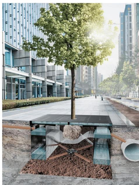
Foto 47: Baumrigole schematisch (Fa. Humberg)
